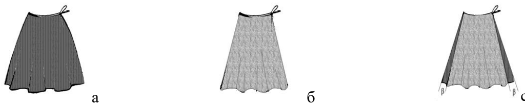
Рисунок 3.Изменение параметров формы с изменением свойств материала
